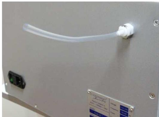
**Attention:** il est obligatoire diriger le tube vers le bas parce que si le liquide il va sortir, il va s'infiltrer à l'intérieur de l'appareil et le système électrique subira des dommages.
